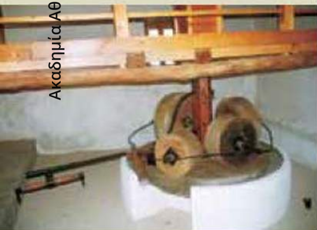
Σάλακος, Ελαιοτριβείο. Ελαιόμυλος με τέσσερις μιλόπετρες, 2008.
