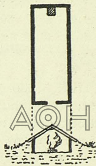
Εἰκ. 62. Κάτωφιν και τομὴ μιᾶς ήμιυπογείου καλύβης παρὰ τό Tuzi. (Nopcsa, Albanien, εἰκ. 1).
